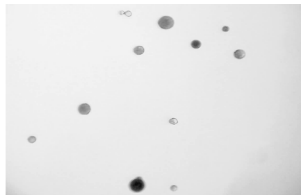
图5 160倍显微镜下微胶囊的表面结构
